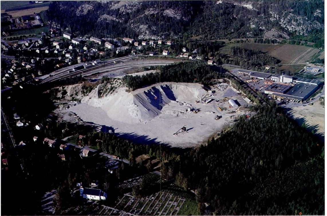
Fig. 12. Eidanger israndavsetning (402542) sett mot nord. Store deler av ryggen, som er bygget opp til 78 m o.h. er fjernet ved uttak til tekniske formål.
