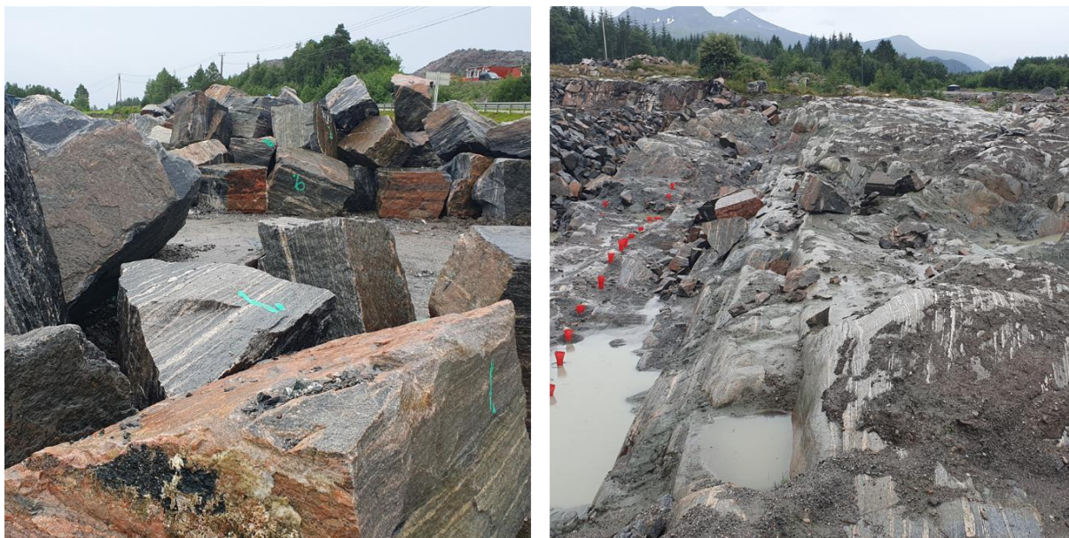
Figur 11. Gunstig spaltbarhet langs steiltstående gneisbånding (spalteplan) kombinert med gunstige tverrsprekker gir god murestein i Gjermundnes, lokalitet 15.
