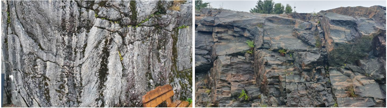
Figur 9. Eksempler på dårlig muresteinkvalitet. Venstre: foldete spalteplan (Jørnøya rasteplass, mellom lokalitet 4 og 5); høyre: folding og ufullstendig utviklete spalteplan (Sveggen, lokalitet 5).
