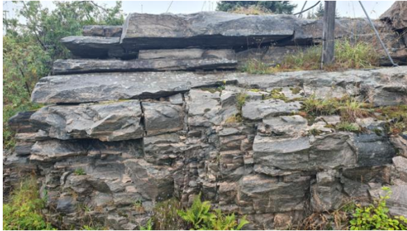
Figur 12. Venstre: ganske gunstig spaltbarhet langs horisontal gneisbånding (Sveggen, lokalitet 5); høyre: gunstig spaltbarhet langs skråstilt gneisbånding og gunstige tverrsprekker (Langs fylkesvei 666, nord for Angvika).
