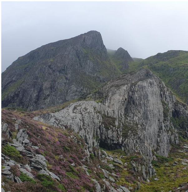
Figur 15. Diffus til foldet gneisbånding, men kraftig utviklete, vertikale tverrsprekker (Blåfjellet/Hidsneset – ikke langt fra lokalitet 12).
