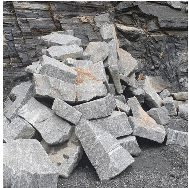
Figur 14. Diffus til foldet gneisbånding horisontalt, men med kraftig utviklet system av vertikale tverrsprekker med resulterende god murestein (Håvik, lokalitet 13).
