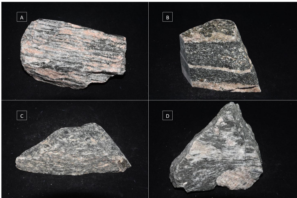
Figur 6: Forskjellige gneistyper fra Møre og Romsdal. (A) Granittisk gneis, (B) Granodiorittisk gneis, (C) Granittisk øyegneis og (D) Mylonittisk gneis. Alle bilder har en lengde som representerer 15 cm i virkeligheten.
