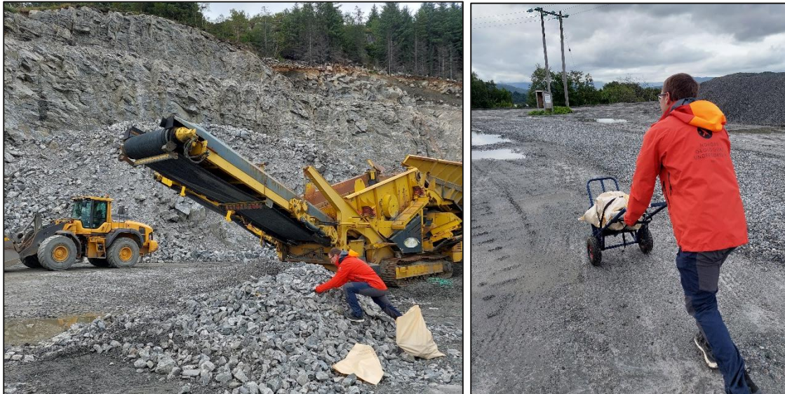
Figur 4: Prøvetaking i pukkverk. Prøvemateriale fylles i to sekker og må enten bæres til bil eller trilles om innkjøring ikke er mulig.
