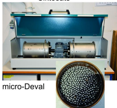
Figur 18: For å vurdere kvaliteten til steinmaterialet benyttes Los Angeles-metoden (LA), micro-Deval-metoden (MDE), og Kulemøllemetoden (KM) med knusing og sikting av materialet. Bilde hentet fra https://www.ngu.no/geologiske-ressurser/egenskaper-og-krav-til-sand-grus-og-pukk
