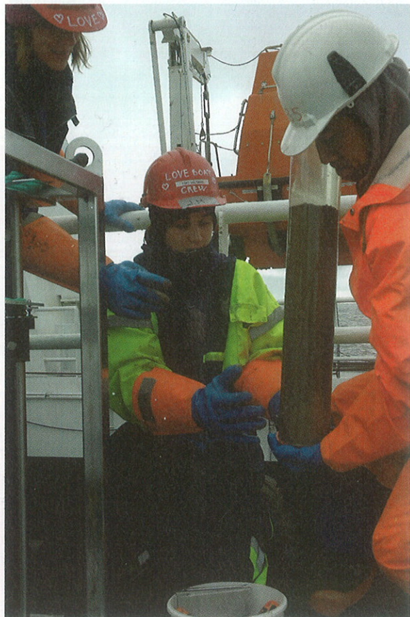
BUNNPRØVER: Jenny Macicali overleverer prøver fra rørene som har vært skutt ned i havbunnen til Jay Zhu.
