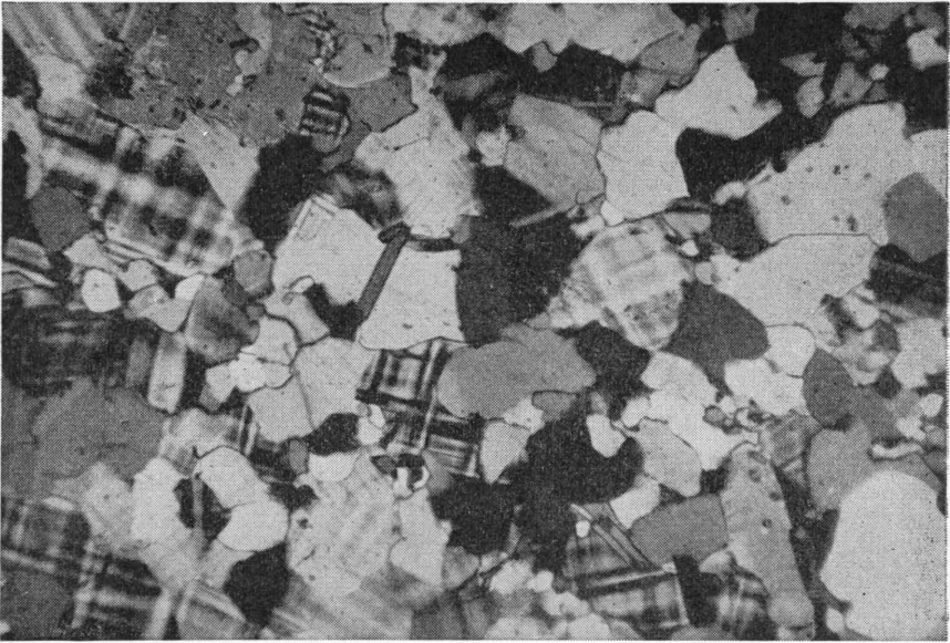
Fig. 7. Rombak granite, undeformed, normal type, Skjomen. The minerals are microcline, quartz, biotite and sericitized plagioclase (upper left corner) (+n, 35x). Rombakgranitt, udeformert, normal type, Skjomen. Mineralene er mikroklin, kvarts, biotitt og sericittisert plagioklas (øvre venstre hjørne) (+n, 35x).
