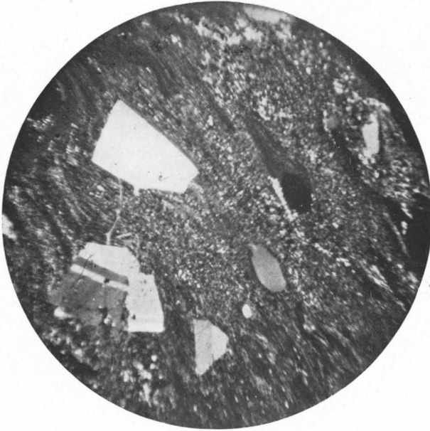
Fig. 1. Kvartsporfyrit, rullesten i kvartskonglomerat, østsiden av Grønsendknipen. Forstørrelse ca. 25, Nic. +. I en fluidalstruert grundmasse ligger krystaller av oligoklasalbit og kvarts. Sml. s. 30—31.
